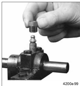
Abb. 2-1 Zerk-Lock-Körper auf den Schmiernippel setzen
