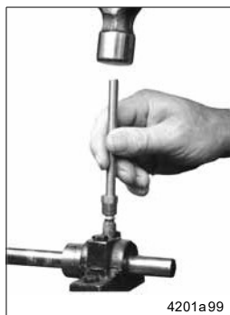
Abb. 2-2 Montage des Zerk-Lock-Körpers mittels Treibwerkzeug
