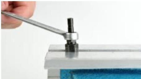
o Stutzen bündig einschrauben (im Uhrzeigersinn)
