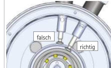
Pumpenelement Montage Abb. 9
