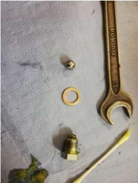
Kugel, Dichtring und Schraube / Feder reinigen
