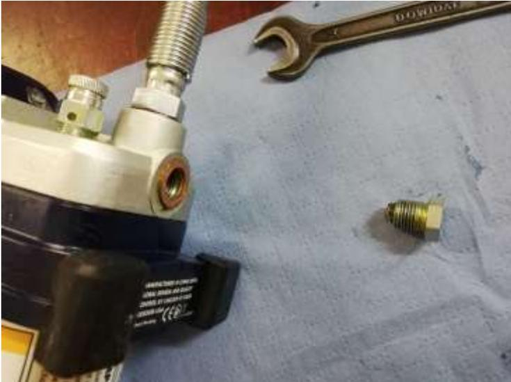
Schraube mit Feder entfernen.
