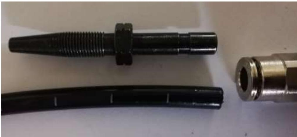
Steckverschraubung mit 1 umlaufenden Rille und SKF Aufdruck ist für beides geeignet.
