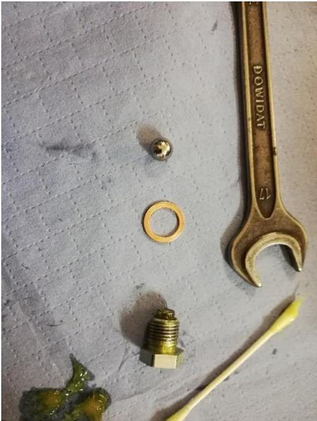
Kugel, Dichtring und Schraube / Feder reinigen
