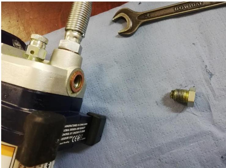
Schraube mit Feder entfernen.
